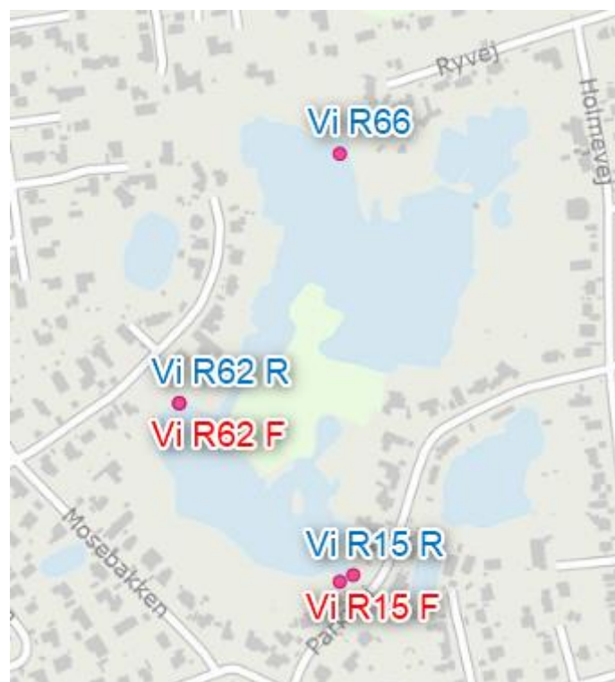
Figur 3. Overløbsbygværker ved Kollelev Mose. R=regnvandskloak, F=fælleskloak /4/.
